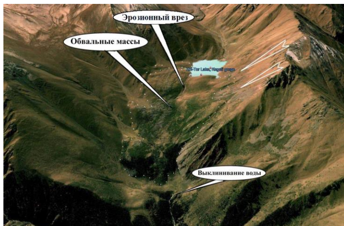
Рис. 15. Озеро Коль-Тор, образовавшееся за счет подпруживания р. Коль-Тор обвалом (бас. р. Кегети, хр. Киргизский). Стрелками показаны направление и область срыва обвальных масс.
