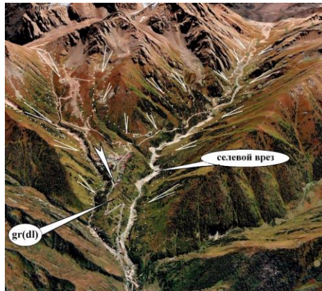
Рис. 10 Селеопасная долина р. М. Алматинка (хр. Заилийский Ала-Тау, Казахстан). Селевой врез – на субстрате псевдоморен в виде деляп-сивных гравитационных отложений. Стрелками показаны направление и область срыва (оползания) полигенетических склоновых отложений, которые стали исходным материалом для деляпсивных гравитационных отложений.
