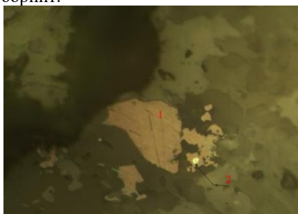
Рис. 6. золото (2) изометричное в борните. размер золотины 0,007x0,007 мм. 1-борнит. ширина кадра 0,25 мм.
