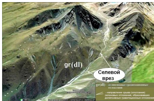
Рис. 6. Верхняя часть долины р. Зындан. На снимке показаны селевой очаг в виде селевого вреза, морфо-литологический субстрат, на котором развился этот врез, и селевое русло
