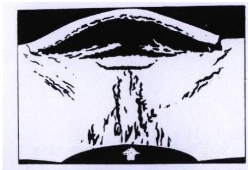
Рис.5. Поперечное сечение стальной пластины, показывающее систему сколов, возникших в результате ударной волны (снизу) (Rinehart, Pearson, 1954)
