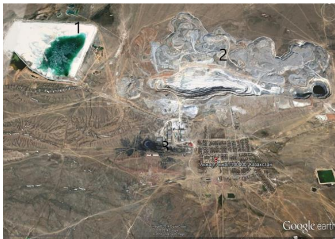
Рис.2. Карта-схема промплощадки №1 месторождения Акжал: 1 - хвостохранилище; 2 – карьер Центральный (действующий) и карьер Восточный (эксплуатация приостановлена); 3- обогатительная фабрика; передвижная дробильно-сортировочная установка; временный склад руды; отвал вскрышных пород; шлакоотвал (Золоотвал); отвал легкой фракции (2 ед.); промышленная котельная; угольный склад; склад ГСМ; химическая лаборатория; РСУ; механический цех; кузница; ремонтно-монтажный цех; автотранспортный комплекс; АБК (столовая в здании АБК); медицинский центр; участок хранения материалов и оборудования
